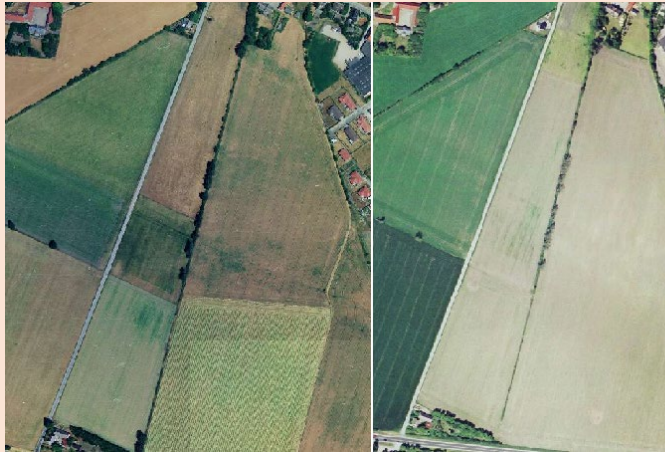
Figur 22) Foto t.v. 1992: Diget er uden gennembrud. Forhold uændret indtil luftfoto fra 2002. Foto t.h. 2002: Sydlige brud er lavet mellem 1999 og 2002.
