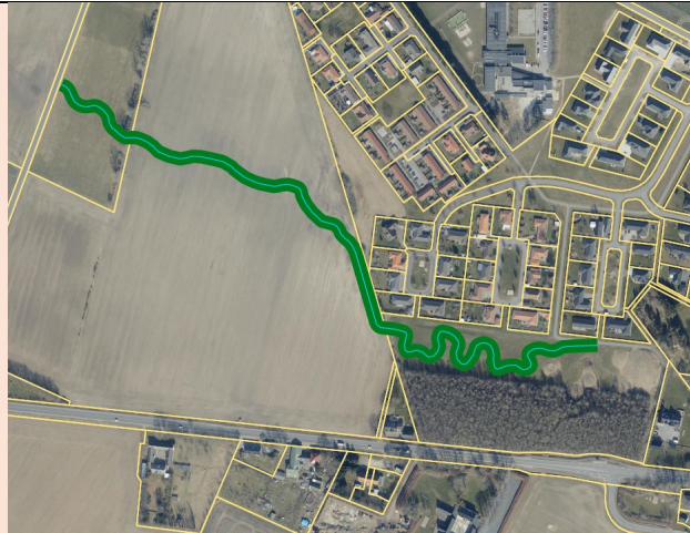
Figur 33) Planlagt tracé for genåbning af rørlagt vandløb.
