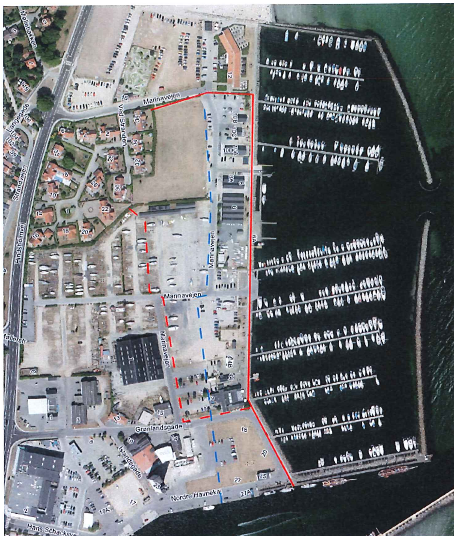
Figur 7.3: 2 mulige placeringer af stormflodssikringen. Stiplet linie er den anbefalede højvandsmur
