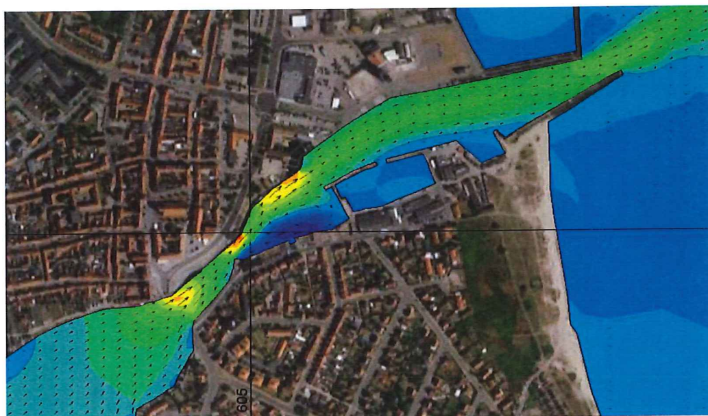
Figur 4.3: Strømhastigheder ved udgående strøm. Gult er største hastighed
