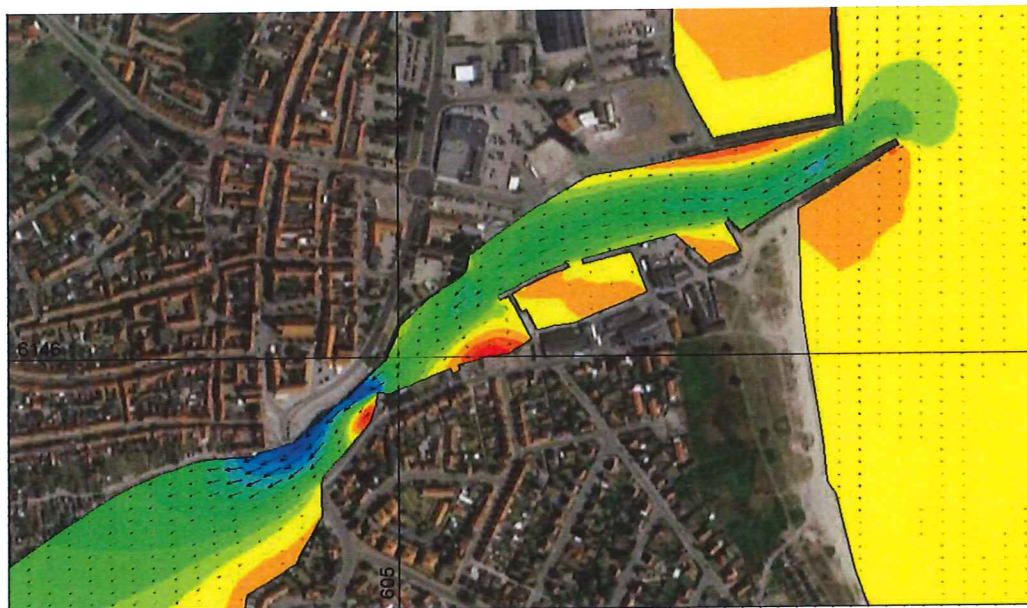
Figur 4.2: Strømhastigheder ved indgående strøm. Blåt er største hastighed
